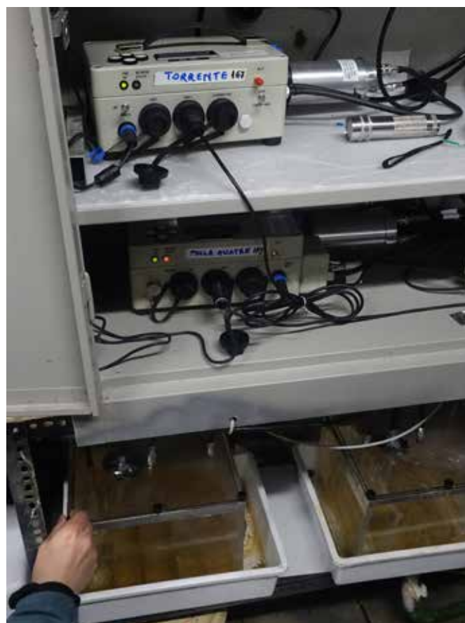
Figura 16 – Misurazione del radon con sistema di acquisizione dati in continuo in due corpi idrici entro la grotta di Bossea (Frabosa Soprana, Cuneo) – ph F. Mantelli
